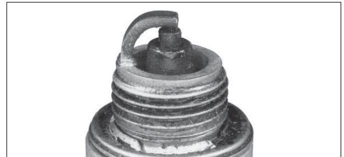
Eine nasse Zündkerze ist das Ergebnis von zu viel Kraftstoff oder Öl im Brennraum. Überschüssiger Kraftstoff kann durch einen verstopften Luftfilter, ein Vergaserproblem oder den Betrieb des Motors mit zu viel Choke verursacht sein. Öl im Brennraum wird normalerweise durch einen verstopften Luftfilter, ein Entlüfterproblem oder durch verschlissene Kolbenringe oder Ventillführungen verursacht.
