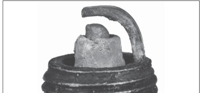
Bei einer verschlissenen Zündkerze ist die Mittelelektrode abgerundet und der Elektrodenabstand größer als vorgeschrieben. Ersetzen Sie eine verschlissene Zündkerze sofort.
