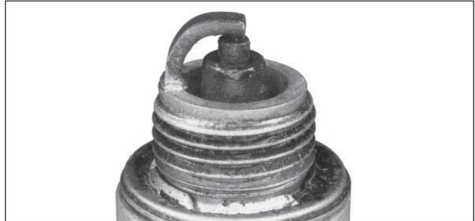
Eine nasse Zündkerze ist das Ergebnis von zu viel Kraftstoff oder Öl im Brennraum. Kraftstoffüberschuss kann durch einen zugesetzten Luftfilter oder ein Kraftstoffgemischproblem verursacht sein. Öl im Brennraum wird normalerweise durch einen verstopften Luftfilter, ein Entlüfterproblem oder durch verschlissene Kolbenringe oder Ventildführungen verursacht.
