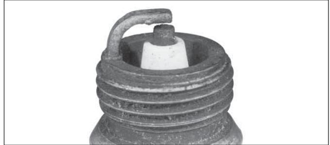
Weißer kalkartige Ablagerungen sind Anzeichen für zu hohe Verbrennungstemperaturen. Meistens sind in diesem Fall auch die Elektroden sehr stark verschlissen. Hohe Verbrennungstemperaturen werden durch zu magere Kraftstoffgemischeinstellungen, Falschlufansaugung oder einen nicht korrekten Zündzeitpunkt verursacht.
