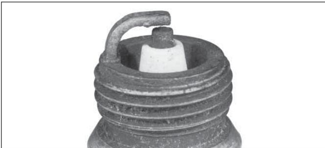
Weißer kalkartige Ablagerungen sind Anzeichen für zu hohe Verbrennungstemperaturen. Meistens sind in diesem Fall auch die Elektroden sehr stark verschliffen. Hohe Verbrennungstemperaturen werden durch zu magere Kraftstoffgemischeinstellungen, Falschlufansaugung oder einen nicht korrekten Zündzeitpunkt verursacht.
