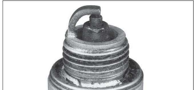
Eine nasse Zündkerze ist das Ergebnis von zu viel Kraftstoff oder Öl im Brennraum. Überschüssiger Kraftstoff kann durch einen verstopften Luftfilter, ein Problem mit der Kraftstoffmischung oder den Betrieb des Motors mit zu viel Choke verursacht sein. Öl im Brennraum wird normalerweise durch einen verstopften Luftfilter, ein Entlüfterproblem oder durch verschlissene Kolbenringe oder Ventillführungen verursacht.
