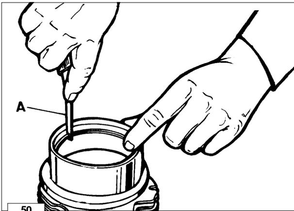
**Kolbenringe - Distanz zwischen den Ringenden (mm)**
